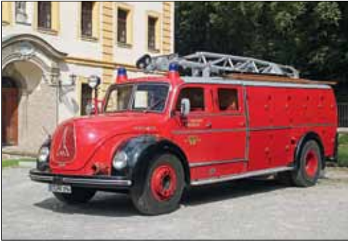
Rüstkraftwagen: RKW 7 von Magirus auf KHD-Fahrgestell S 6500 von 1954. Das Fahrzeug stand bei der FF Reutlingen im Einsatz und wird heute von einer Gruppe Idealisten erhalten. Der Kranausleger schafft es, 7 t zu heben.
