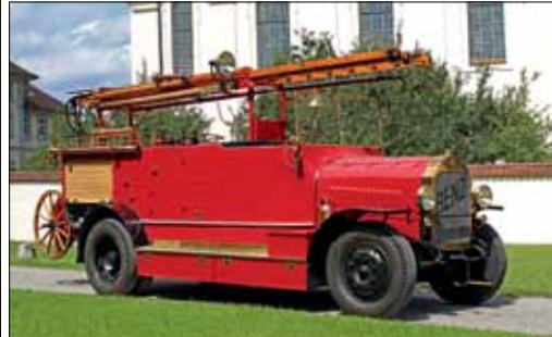
Schmuckstück: Automobilspritze Benz-Gaggenau (Typ 2 CSN), Jahr- gang 1924, aus dem Feuerwehrmuseum in Winnenden. Der Benzinmotor leistet 40 PS. Der Aufbau stammt von Carl Metz (Karlsruhe).
