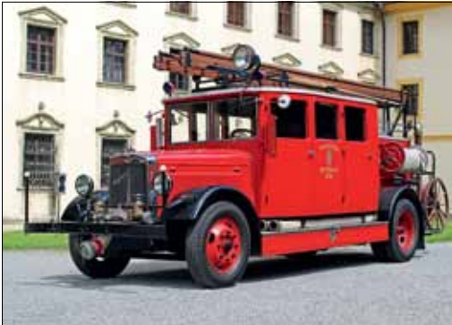
Prächtig: Magirus-Autospritze (Kraftfahrtspritze KS 15) Typ M 27, 70 PS, Baujahr 1935, der FF Ehingen/Donau. Förderleistung der Vorbaupumpe 1.500 l/min. Im Heck ist eine TS 8/8 eingelagert.
