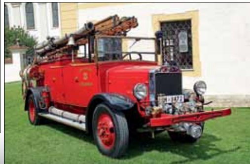
Mit TS im Heck: Autospritze LF 12, Baujahr 1932, der FF Herrenberg. Fahrgestell Daimler- Benz/Gaggenau, 60 PS, Vorbau- pumpe Magirus, Leistung 1.200 l/min.
