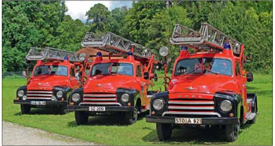
Noch aktiv: Drei Drehleitern DL 18, Baujahr 1959 bzw. 1960, auf Opel Blitz-Fahrgestell mit Leiteraufbau von Magirus. Die DL 18 in der Mitte steht noch heute im Einsatzdienst.
