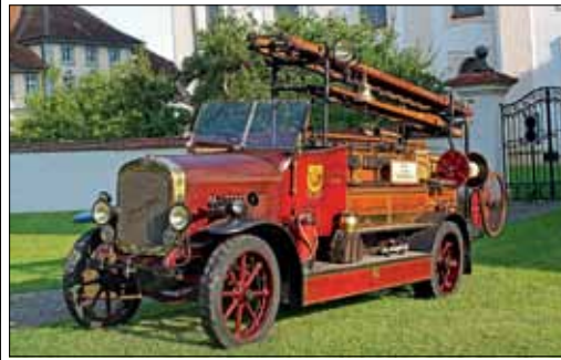
Ältestes Exponat: Magirus-Kraftfahr- spritze KS 20 von 1923 mit 4-Zylinder- Benzinmotor und 70 PS der FF Bad Urach.
